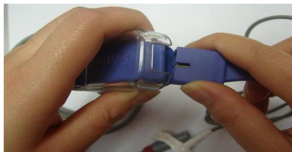
**Fig 12-6 Connessione tra sensore e estensione del cavo (2)**
