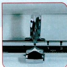
La regolazione dello zero garantisce la determinazione del peso netto, deducendo il peso supplementare del tappetino o del pannolino.
