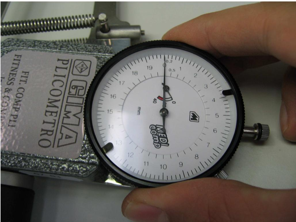
Riavvitare il pomolo. Aprire la morsa del plicometro ed interporre la lamina dinamometria dalla parte elastica fra le due guance del plicometro, tenendo l'estremità della stessa a filo del bordo interno della morsa del plicometro...
