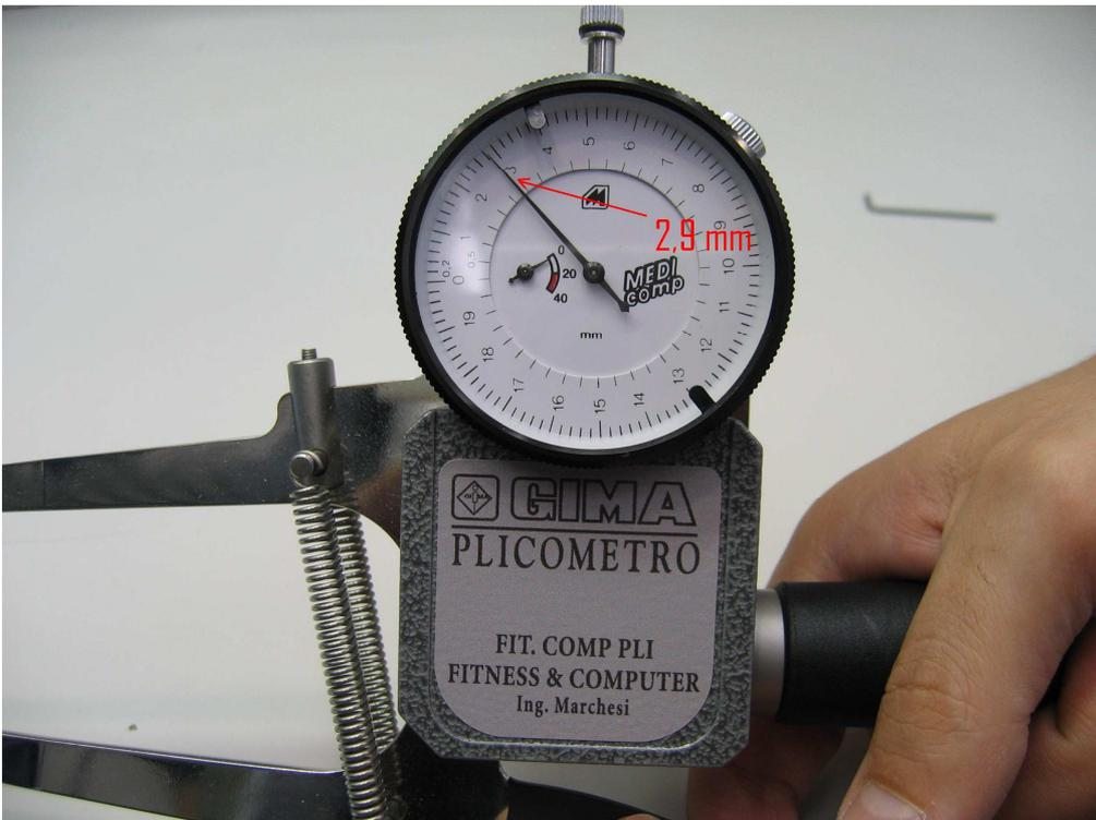
...regolate la vite a brugola che si trova sul distanziatore del plicometro, in modo da tendere le molle sino ad ottenere la misura di 2mm +/- 0,2mm...
